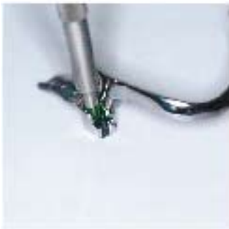
Bild 13 Drücken Sie die Matrize in den Modellguß, bis sie einrastet.
